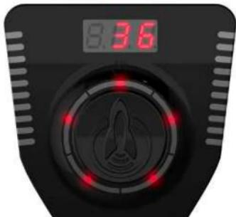
После завершения каждой обработки «Феникс» переходит в «режим блокировки» на 36 часов. После включения аппарата все линии обработки загорятся красным. При этом на дисплее отобразится число (обратный отсчет от 36), которое показывает, сколько времени необходимо подождать, прежде чем можно использовать аппарат снова.
