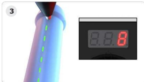
При выполнении процедур вдоль линии обработки цифровой дисплей отсчитывает количество оставшихся проходов вдоль этой линии.
